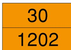
**Die obere Nummer** steht dabei für die Gefahr, die von dem transportierten Stoff ausgeht (in diesem Beispiel bedeutet „30“ ein entzündbarer flüssiger Stoff mit einem Flammpunkt von 23°C bis einschließlich 60°C).
